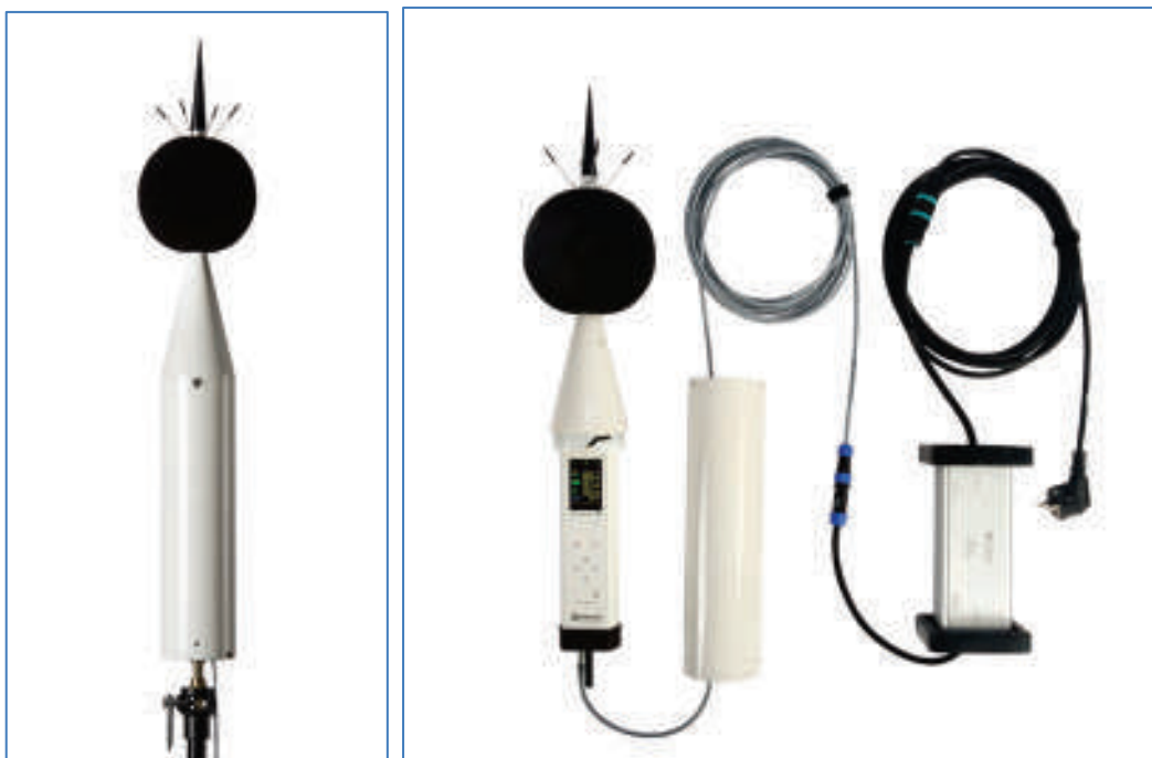
Figura 3 – Cabina di monitoraggio Svan307
